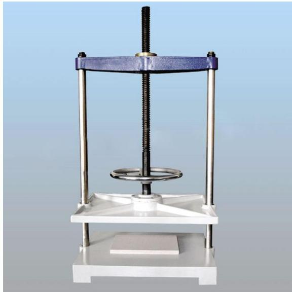
E' realizzata in acciaio inox, altezza e pressione è regolata dal volantino manualmente.può raggiungere una pressione fino a due tonnellate.
